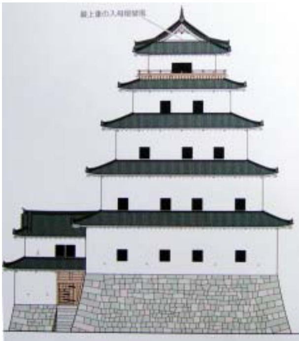
丹波亀山城 最上階以外の破風のない天守。 5重5階 左南面 右西面（初期層塔型天守）（図は「天守のすべて 学研」より）
